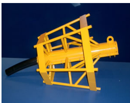
取水管の先端とそれを支えるフレーム
