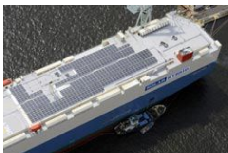
甲板に太陽光パネルを設置した自動車運搬船「エメラルド・エース」 株式会社商船三井
