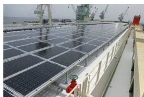
甲板に太陽光パネルを設置した自動車運搬船「エメラルド・エース」 株式会社商船三井
