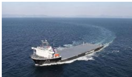
空気の泡で摩擦を減らして航行するモジュール運搬船「ヤマト」 日之出郵船株式会社
