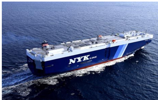
世界初の太陽光発電実用化自動車運搬船「アウリガ・リーダー」 日本郵船株式会社
