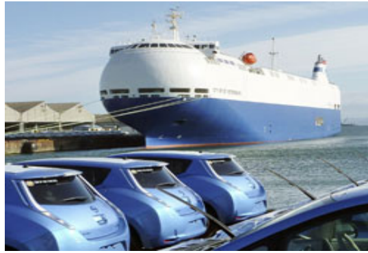
旭洋造船が建造した風圧の抵抗を軽減する省エネ型自動車運搬船 「シティ・オブ・セント・ピーターズバーグ」
