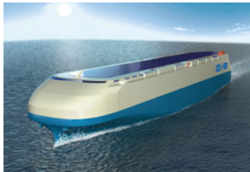
空気抵抗の少ない船体デザインと太陽光パネルが特徴的な次世代の 自動車専用船「ISHIN-I」の航行イメージ ©株式会社商船三井
